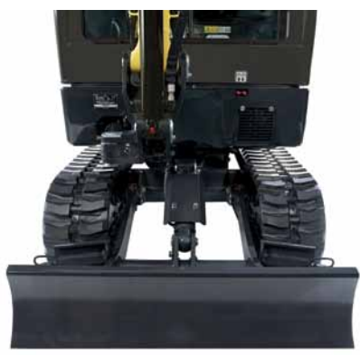
Сдвинутая ходовая часть: 980 мм
